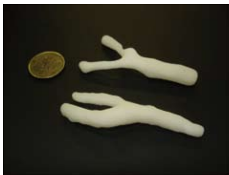
Fig. 10. Modelos físicos de arterias carótidas patológicas resultantes del procesamiento completo de las imágenes respectivas
