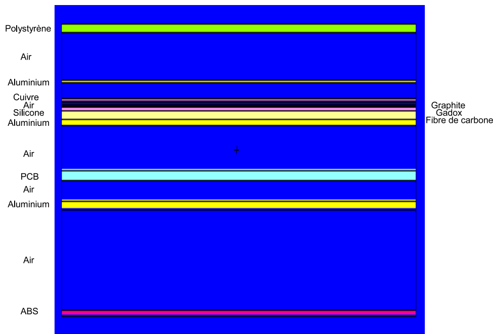
FIG. 4.12 – Schéma représentatif de la modélisation de l'imageur iViewGT . Le schéma est à l'échelle.
