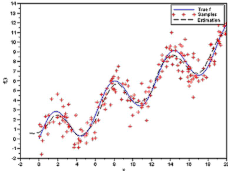
Figure 1: Régression (ligne pointillée) effectuée à partir de 200 mesures bruitées (échantillons, représentés par les croix). La vraie fonction est représentée par la ligne continue.
