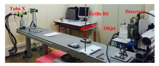
Fig. 9. Banc de test correspondant à la géométrie présentée dans Fig. 4.
