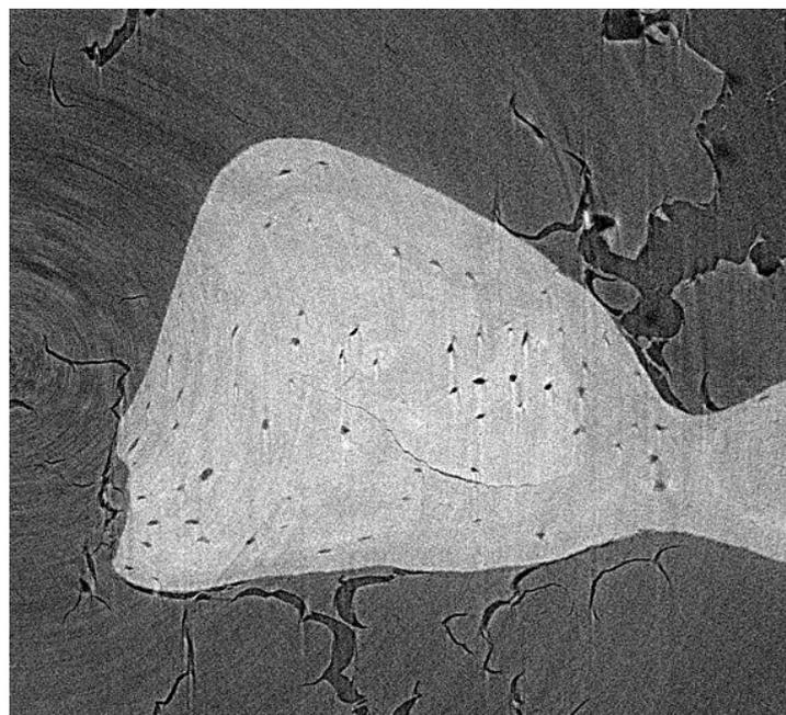
*Figure 2.13 Zoom sur une coupe tomographique à 1.4µm montrant une microfissure et des lacunes*
