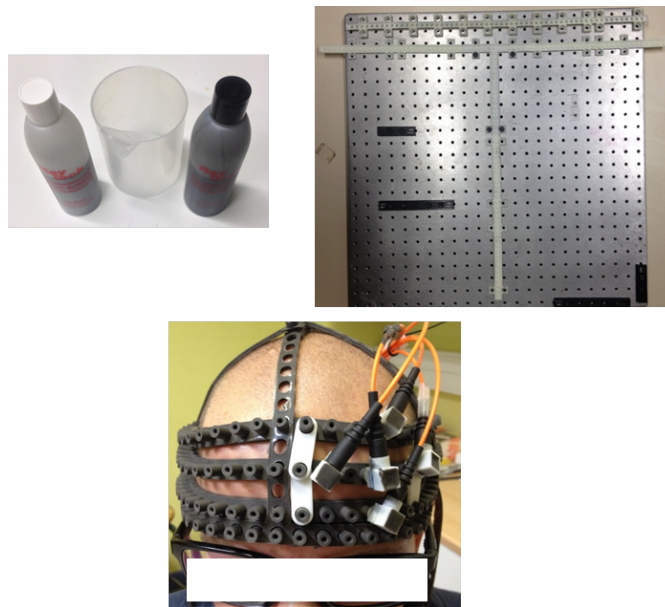
FIGURE 3.12 – Photographie des deux composants à réticulation rapide (à gauche), des moules réalisés (à droite), et du casque mis en place sur la tête d'un sujet, et portant les optodes réalisées (en bas).
