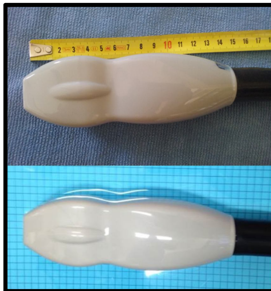
Figure 4.6 – Photographie de la sonde matricielle 2-D de fréquence centrale 3 MHz avec 32 \times 32 éléments et un pitch de 0.3 mm. L'ouverture totale de la sonde est inférieure à 1 cm dans les deux directions.
