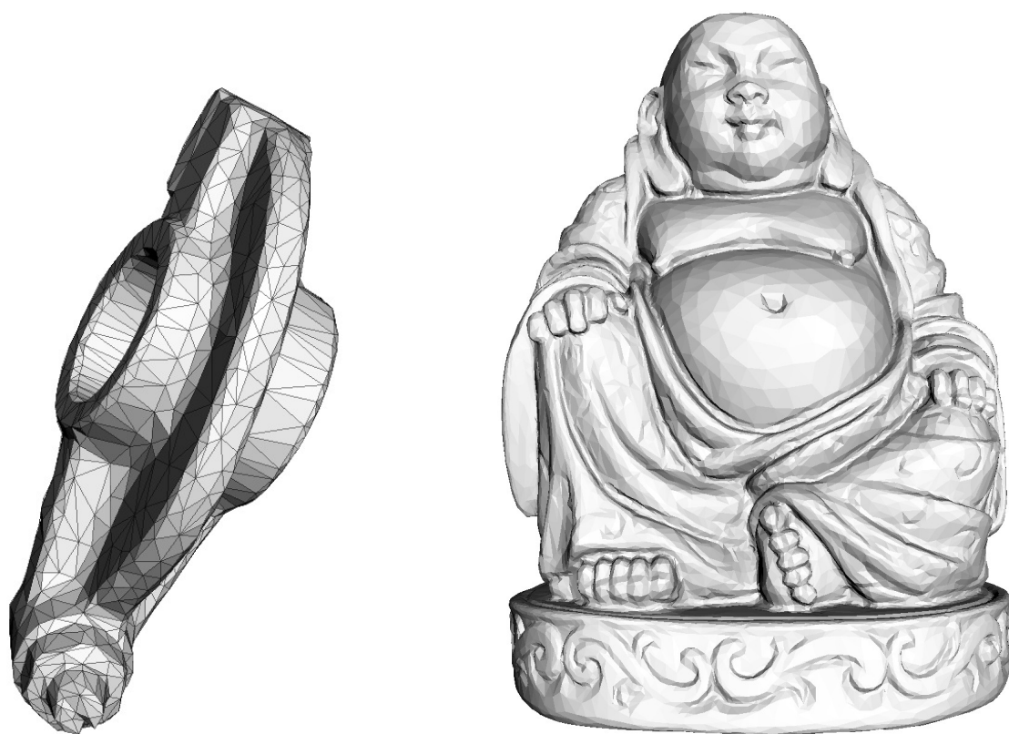
FIGURE 4.12 – Simplifications des modèles rockerarm (1000 sommets) et Buddha (20k sommets).
