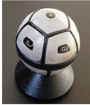
Figure 22: Capteur inductif de proximité 3D comportant 11 inductances plastroniques réparties sur deux demi-sphères (avec composants CMS à l'intérieur des sphères) Collaboration AMPERE/S2P
