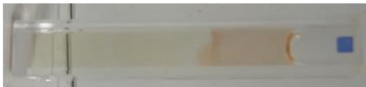
Figure 6-7 : Fantôme des deux états de PpIX dans un gel d'agar. La photo est tournée de 90° dans le sens trigonométrique.
