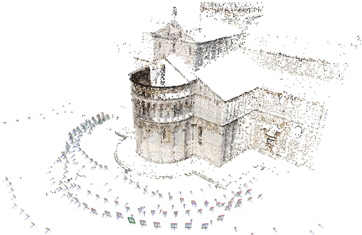
FIGURE 2.24 – Exemple de reconstruction 3D par ajustement de faisceaux. En bas, nous pouvons noter les multiples positions des caméras estimées par l’ajustement de faisceaux pour reconstruire le bâtiment. Crédit : [GHERARDI et collab. \[2010\]](#).
