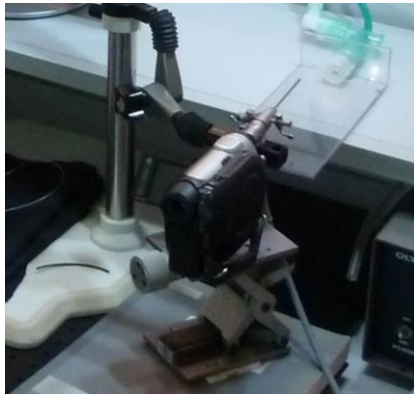
Figure 66 – photo du montage permettant de manier et maintenir en position fixe l'endoscope. Ce montage, utilisé uniquement au cours de la première session d'imagerie du suivi n°1, se compose d'un bras articulé sur lequel est fixée une plateforme (conçue pour les besoins du projet) accueillant le caméscope aligné devant l'endoscope (lui-même fixé sur la plateforme). Deux vis micrométriques de réglage permettent d'aligner le caméscope et l'endoscope.
