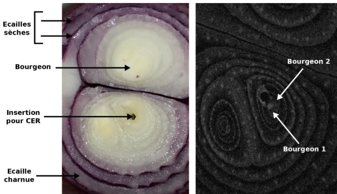
Figure 35 – Illustrations d'une coupe anatomique de l'oignon (gauche) et de l'image de RMN acquise en pondération T1 (droite) avec la bobine volumique.
