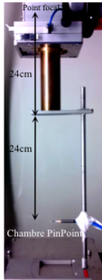
FIGURE 2.9 – Montage expérimental pour la mesure de la CDA dans le XRAD225Cx
