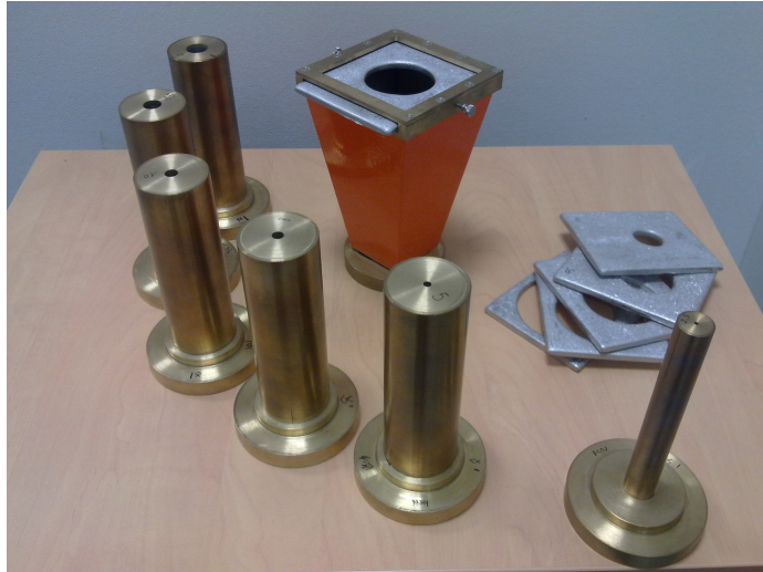
FIGURE 2.5 – Les collimateurs usinés et le collimateur personnalisable avec les inserts en Cerrobend.
