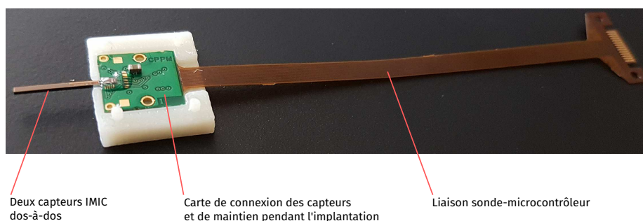
FIGURE 4.6 – Photographie de la sonde MAPSSIC. La sonde est constituée de deux éléments : deux capteurs dos-à-dos qui contiennent les matrices de pixels et une carte de connexion des capteurs et de maintien pendant l'implantation. La carte de connexion s'étend par une partie souple qui permet la connexion au microcontrôleur.
