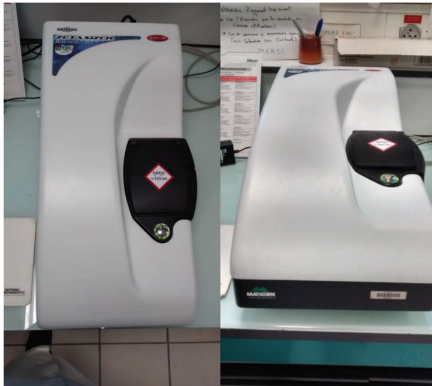
Figure III-1 : Appareil de DLS Zetasizer Nano-ZS de Malvern au CEA.
