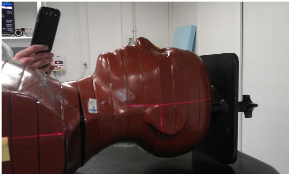
Figure 52 : Vue de la région ORL du fantôme Rando anthropomorphique compose de plusieurs coupes auquel est inséré 17 TLD et irradié par un faisceau d'imagerie MV-CBCT sur un arc de 201° pour un protocole 15 UM.
