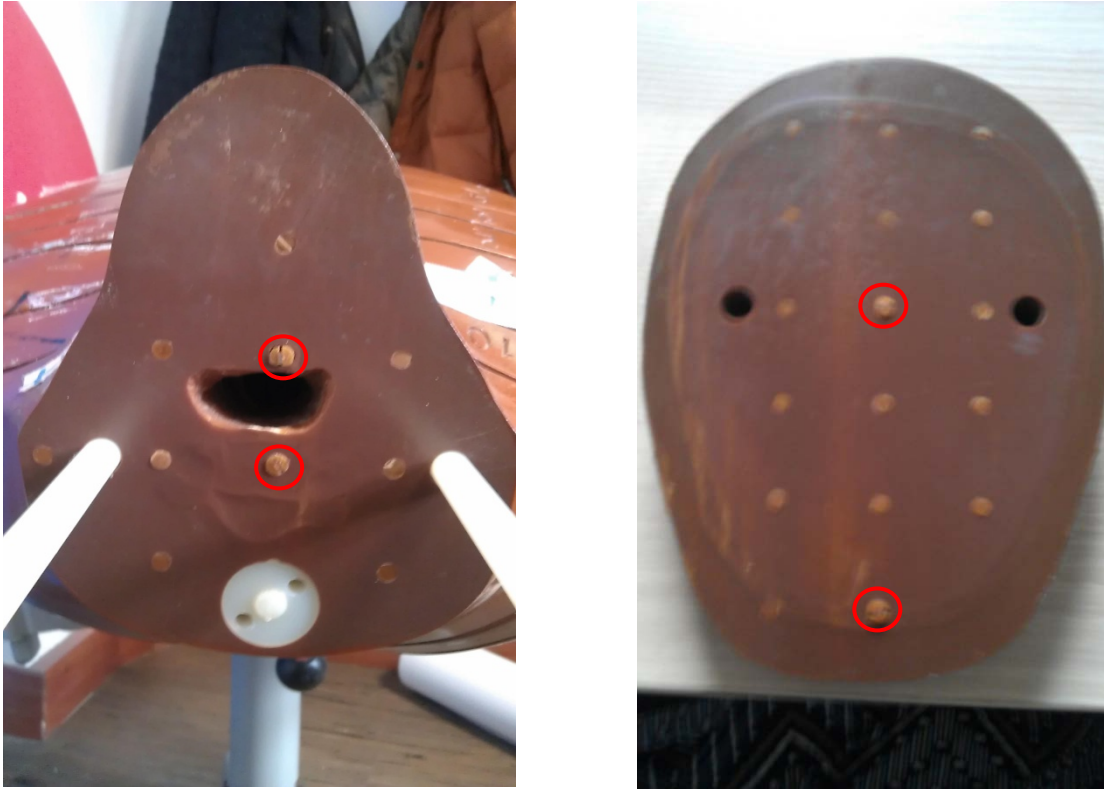
Figure 53 : Exemple de coupes du fantôme Rando anthropomorphe avec entouré en rouge des inserts dans lesquels ont été insérés des TLD de 3 \times 3 \times 1 \text{mm}^3 .
