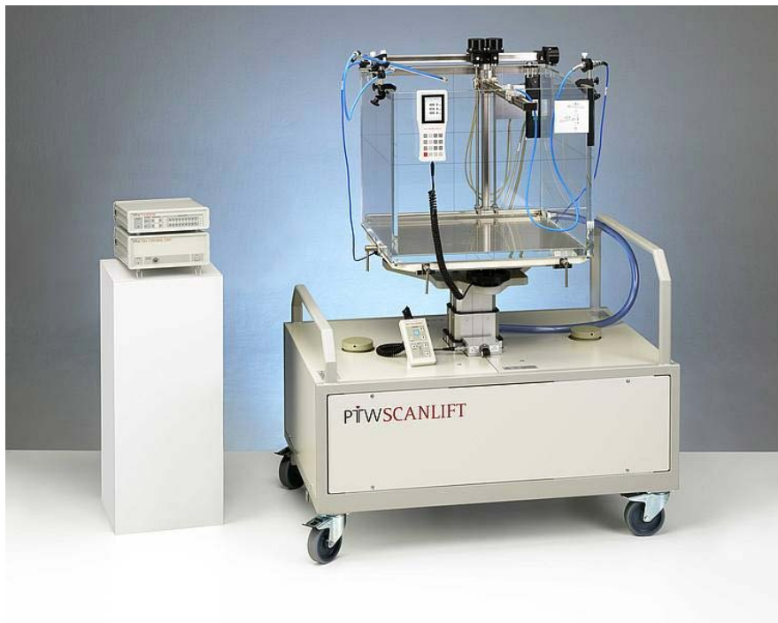
Figure 37: Fantôme d'eau en plexiglas avec emplacements pour insérer et faire bouger la chambre d'ionisation (PTW© Water Phantom).
