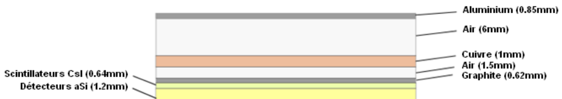
Figure 49 : Représentation schématique de l'imageur portal AG9 EPID simulé avec GATE pour l'imagerie en MV-CBCT et le calcul de dose.
