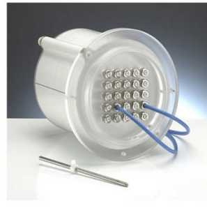
Figure 19 : Fantôme cylindrique Matrix (T40026 PTW) avec les 25 inserts destinés à recevoir la chambre d'ionisation pour la mesure.
