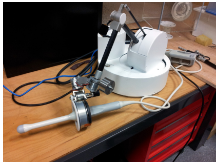
FIGURE 2.7. – Apollo : robot porte-sonde comanipulé, développé au sein du laboratoire ISIR, Paris.
