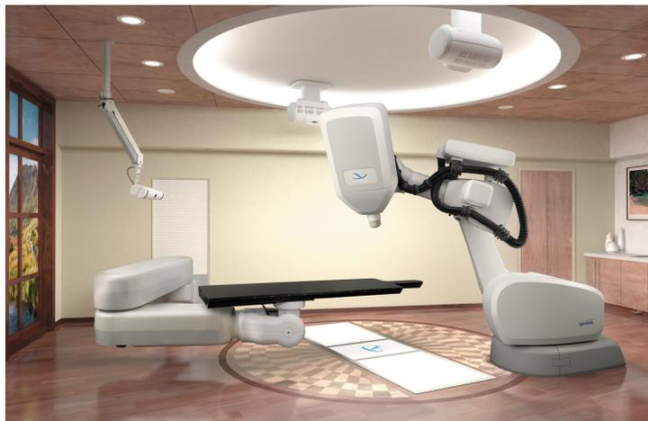
FIGURE 1.9 – Le Cyberknife permet de délivrer la dose en utilisant des faisceaux non coplanaires et en suivant la tumeur grâce à un modèle de mouvement pré calculé qui est vérifié à intervalles réguliers par les 2 sources de rayons X fixées au plafond
