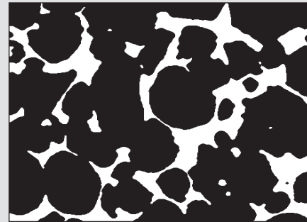
Séparation des classes Alite et Bélite de la classe célite (le fond)
