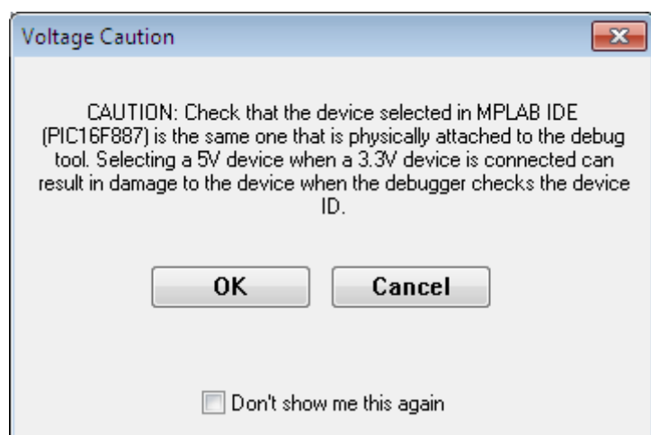
FIGURE 11: Message d'avertissement de compatibilité d'alimentation du microcontrôleur et de debbuger.
